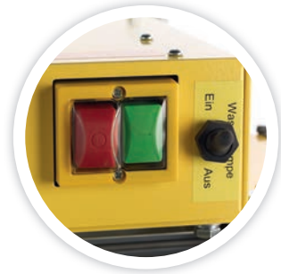
Pompe à eau débrayable pour la coupe à sec
